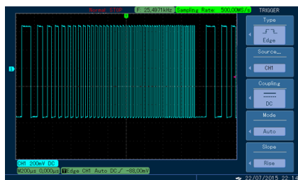
Рис. 123 Наблюдение за формой сигнала развертки частоты с помощью осциллографа
