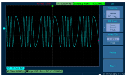
Рис. 45 Осциллограмма сформированного фазо-модулированного сигнала
