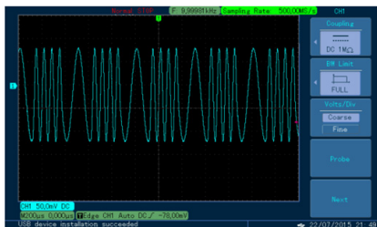
Рис. 36 Осциллограмма сформированного частотно-модулированного сигнала
