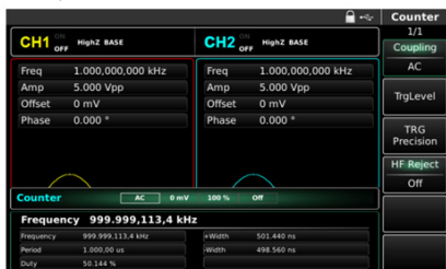
Рис. 15 Измерение частоты с помощью встроенного частотомера
