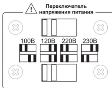
Рис. 3 Переключатель напряжения питания
