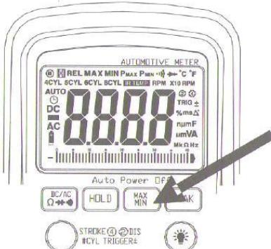
1. Нажать кнопку «**MAX/MIN**» для перехода в режим запоминания максимального и минимального значений параметра. На экране прибора отображается индикатор «**MAX**» или «**MIN**». Прибор переключается в режим ручного выбора диапазона значений и фиксирует максимальное или минимальное показание, которое обновляется в случае превышения предыдущего значения.
