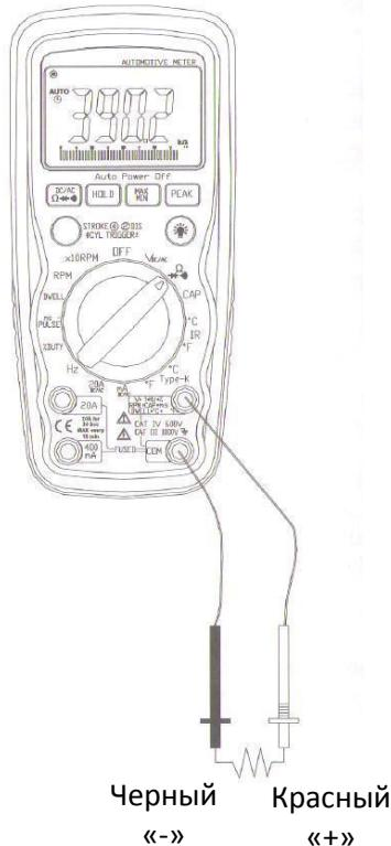
**Режим измерения – проверка диодов (  )**
