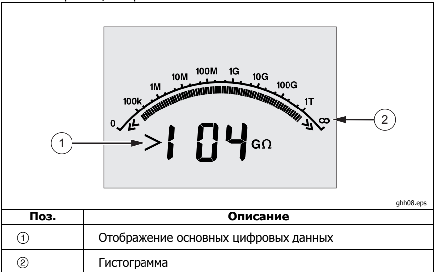
Рисунок 11. Отображение измеренного сопротивления изоляции
