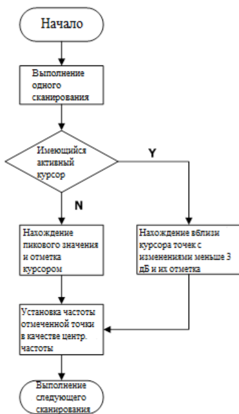
Рис. 2-1 Процесс отслеживания сигнала
