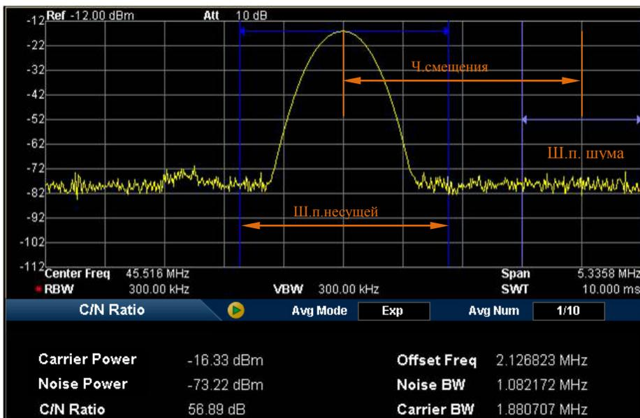
Рис. 2-19 Интерфейс функции измерения отношения несущей к шуму
