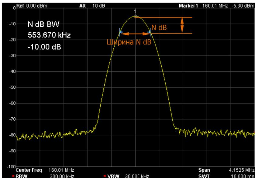
Рисунок 2-25 Схема измерения ширины полосы N дБ
