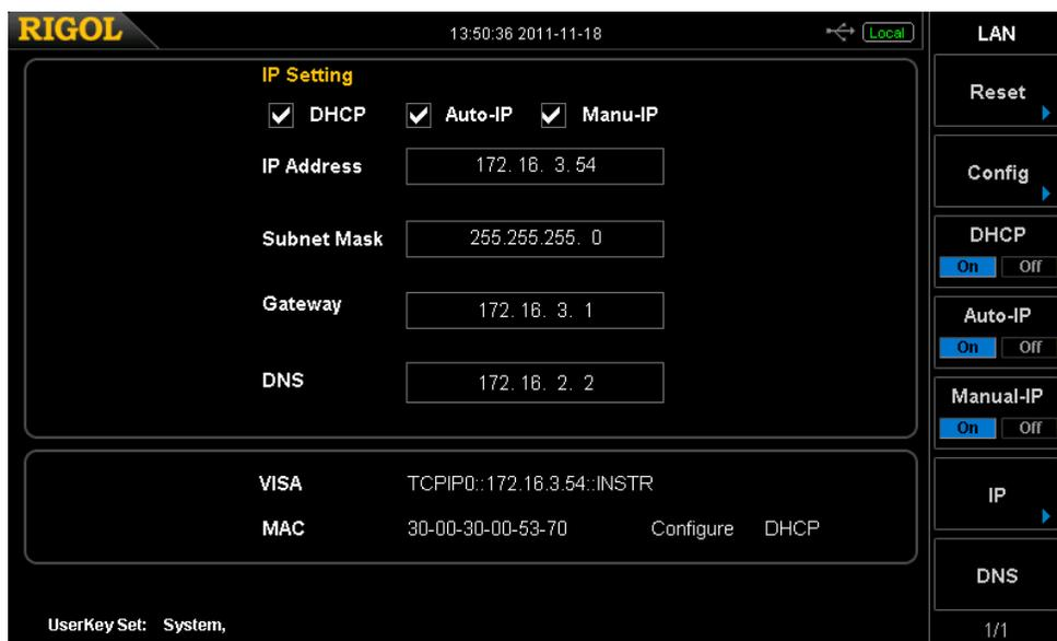
Рис. 2-30 Настройка сетевых параметров (LAN)
