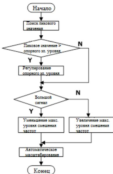
Рисунок 2-8 Процесс выполнения функции автоматического контроля диапазона
