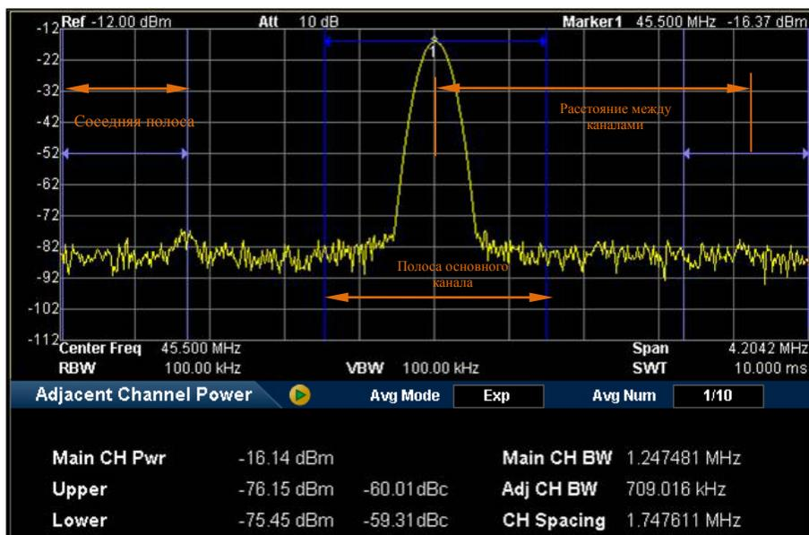
Рис. 2-15 Интерфейс функции измерения мощности соседних каналов
