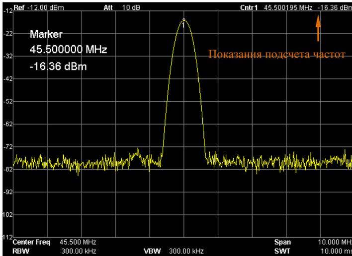
Рисунок 2-26 Измерение подсчета частот
