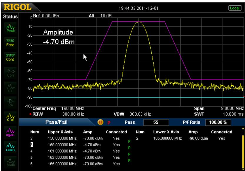
Рис. 2-11 Интерфейс теста соответствия прошел/ не прошел
