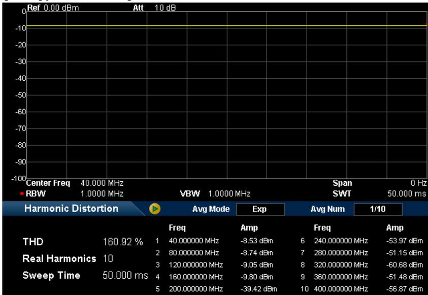
Рис. 2-20 Интерфейс функции измерения искажения гармоник
