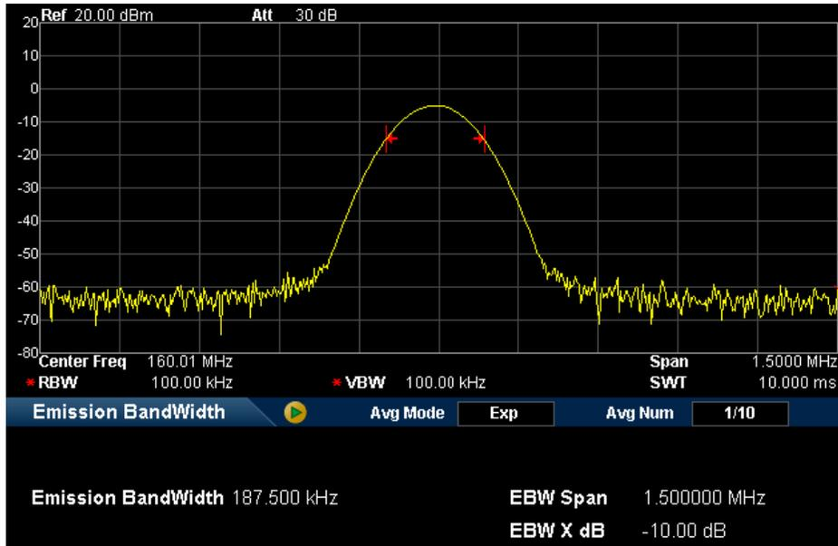
Рис. 2-18 Интерфейс функции измерения ширины полосы передачи
