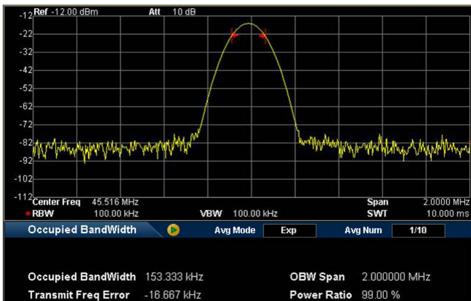
Рис. 2-17 Интерфейс функции измерения занимаемой ширины полосы
