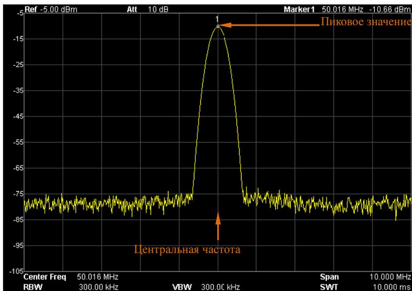
Рис. 2-3 Пиковое значение → После изменения центральной частоты
