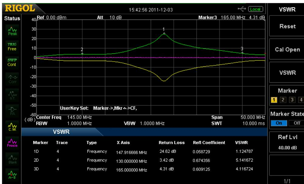
Рис. 2-13 Интерфейс измерения VSWR
