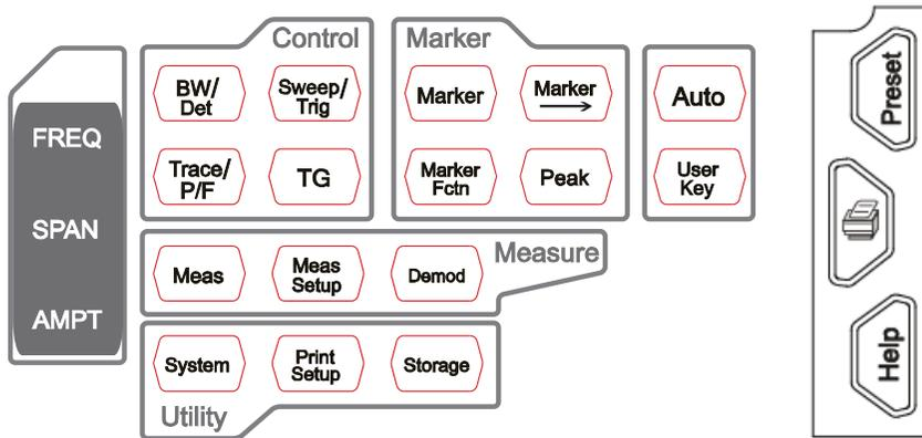
Рис. 1-6 Схема функциональных кнопок передней панели
