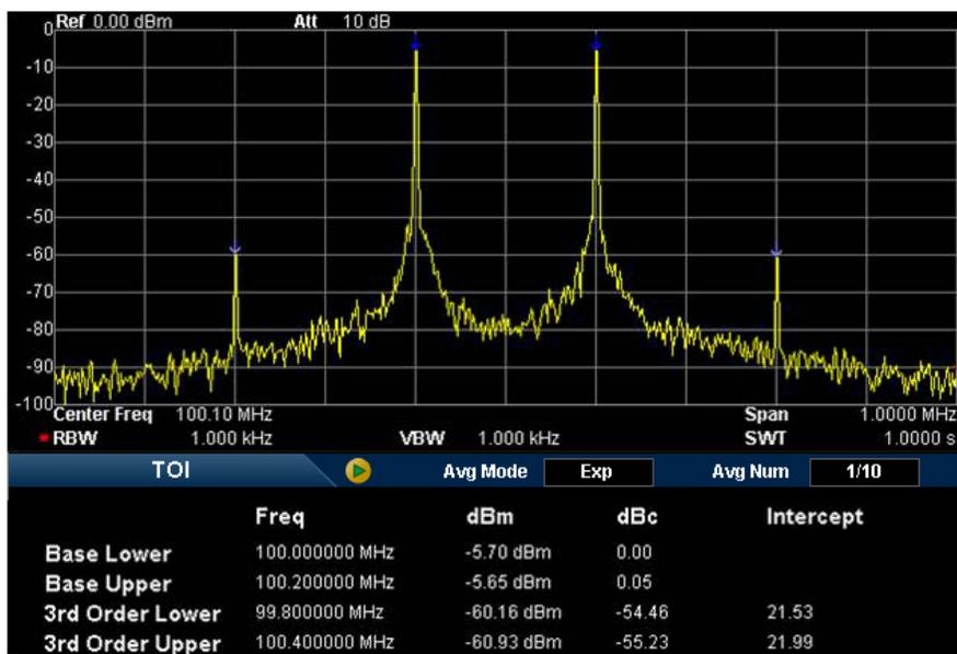
Рис. 2-21 Интерфейс функции измерения интермодуляционных искажений третьего порядка
