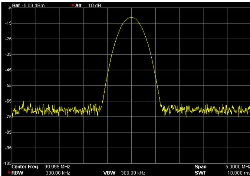
Рис. 2-5 После использования функции автоматического масштабирования
