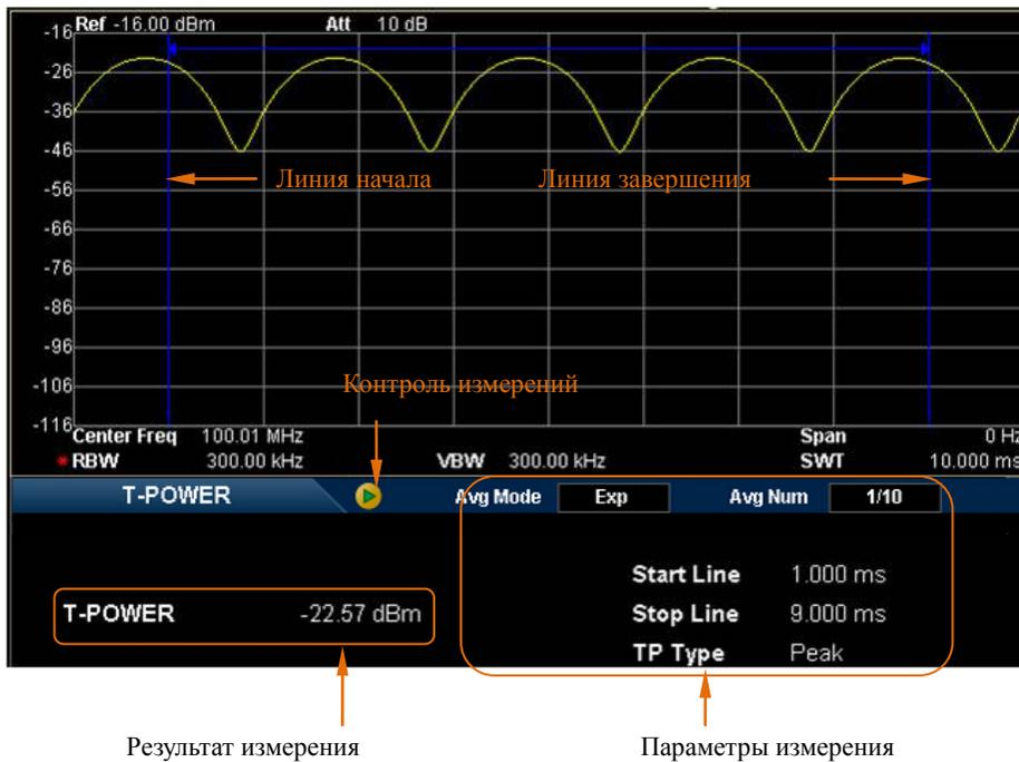
Рис. 2-14 Интерфейс функции измерения мощности временного интервала
