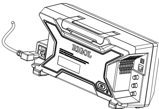
Рис. 1-4 Подсоединение кабеля источника питания
