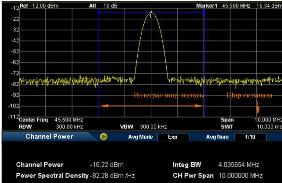
Рис. 2-16 Интерфейс функции измерения мощности канала
