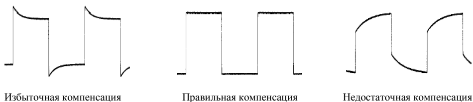
Рис. 1-10 Компенсация пробника
