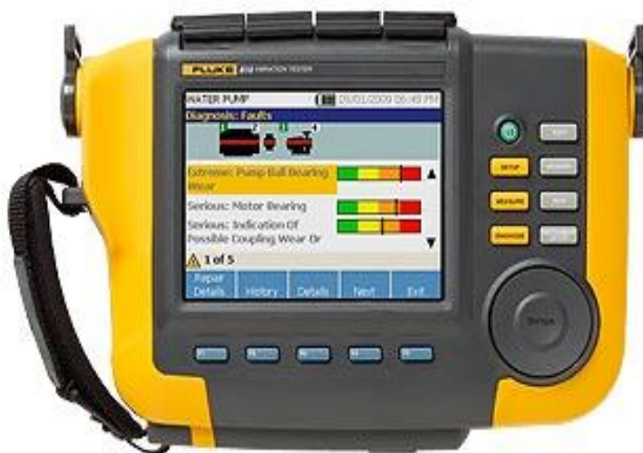
Рисунок 1 - Внешний вид виброметра FLUKE 810
