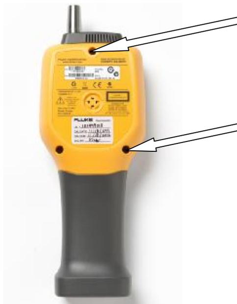
Рисунок 2 – Схема пломбировки счетчика частиц от несанкционированного доступа
