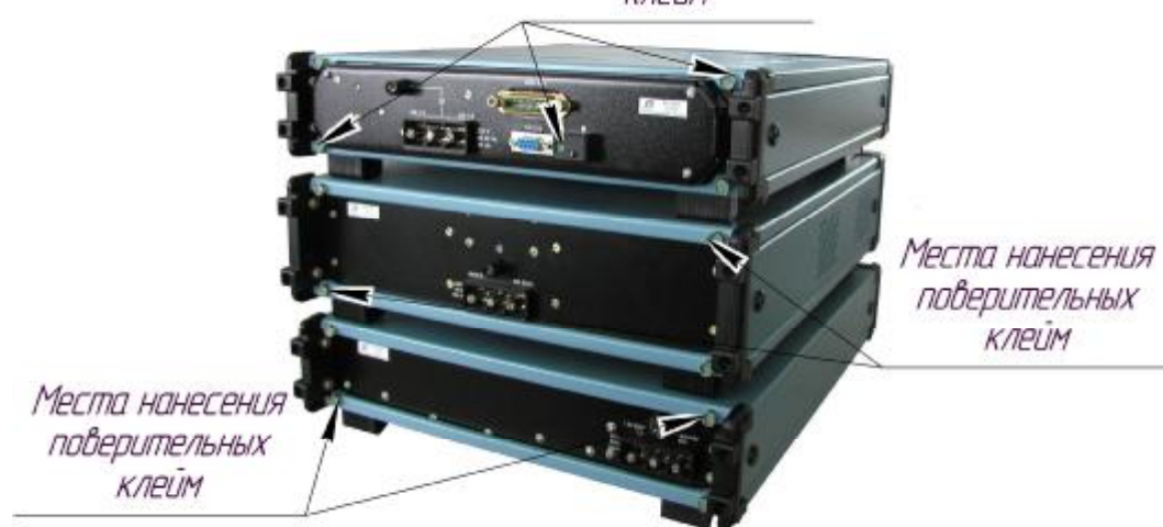
Рисунок 1. Общий вид прибора Места нанесения поверительных клейм
